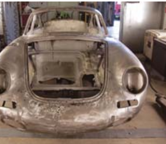
Am Anfang steht die Karosserie. Der Lack muss ab - aber wie? Bis zu metallisch blanken Oberflächen kann der Weg weit sein.
