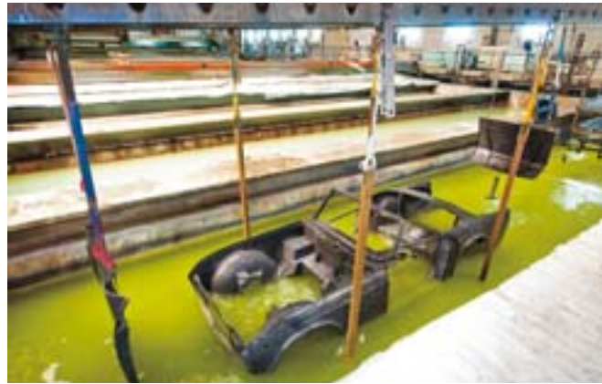
Im Tauchbad entlackt, entrostet und wieder grundiert. Firmen wie Carblast greifen für diese Leistung auf ein Netz von Spezialisten in der Industrie zurück.
