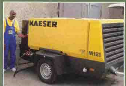
Der große Kompressor liefert bis zu 14 bar Arbeitsdruck und fast unbegrenzte Luftmengen
