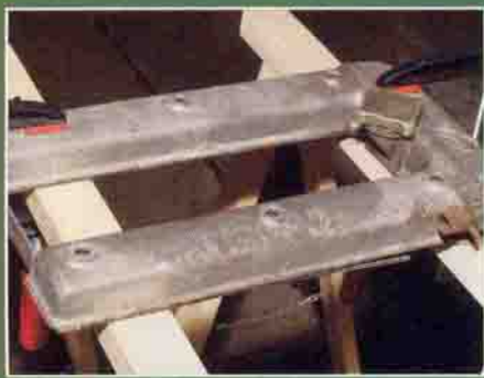
Das erste Testobjekt: der völlig verdrehte Nockenwellendeckel eines Alfa Romeo
