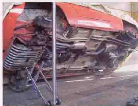
Die Firma CleanTech arbeitet auch in der Werkstatt des Kunden. Idealer Helfer: der Kippwagenheber
