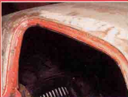
Diagnose mit Trockeneis: Die Türumrandung aus Metall sieht eigentlich noch gut aus, ist...
