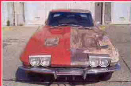
Halbzeit: Die Farbe ist zur Hälfte runter, der erste versteckte Schaden vorn links zu sehen
