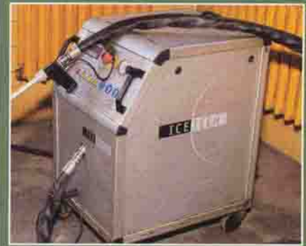
Das Herz des Ganzen: Diese Maschine „schießt“ das Trockeneis auf das Werkstück
