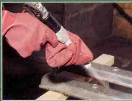
Mit bloßem Auge ist nur ein heller Strahl zu erkennen, die Pellets verdampfen beim Aufprall
