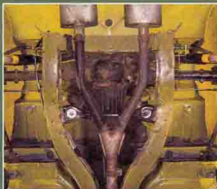
Der gereinigte Rahmen eines Spitfire; Differential und Antriebswellen blieben, wo sie waren
