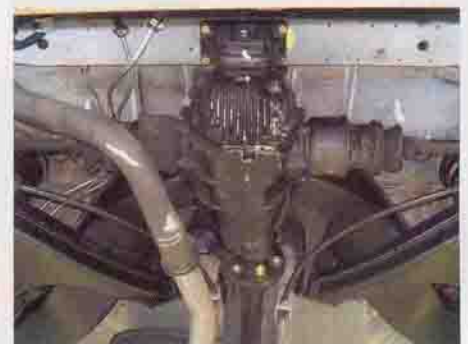
Die Hinterachse eines Mercedes 350 SL nach dem Strahlen – nix wurde demontiert, nix abgedeckt!
