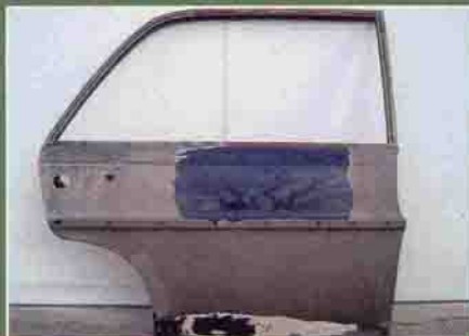
Idealer Einsatzzweck: Das schonende Entlacken empfindlicher Blechteile wie Türen und Hauben
