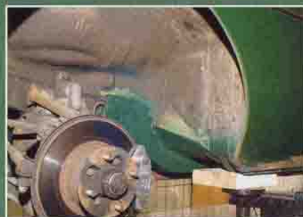
Erstaunlich rostfrei: die gereinigten Radhäuser. Mit der Drahtbürste hätte es etwas gedauert...
