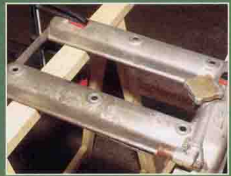
Der Vorher-Nachher-Effekt: Rechts ist bereits die gewünschte originale Oberfläche zu erkennen
