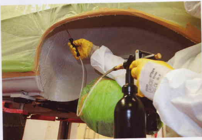
An allen Falzen garantiert Fett eine optimale Schutzwirkung. Für Flächen wie Radhäuser oder Unterböden ist ein Wachs dagegen besser geeignet
