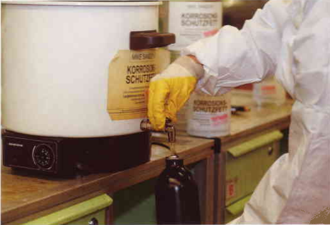
Je nach Viskosität muss das Fett von Mike Sander auf Temperaturen zwischen 40 und 80 Grad Celsius erhitzt werden, erst dann lässt es sich spritzen
