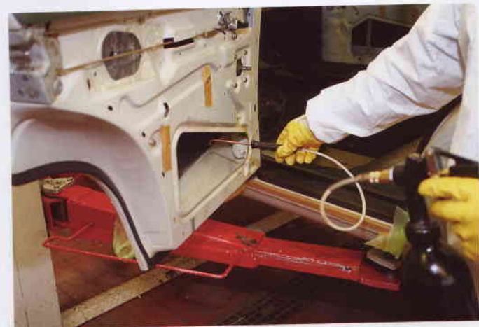
Auch Türböden brauchen Schutz. Allerdings müssen die Fensterführungen ausgespart werden, um Schlierenbildung auf den Scheiben zu vermeiden
