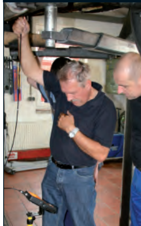
MG TD Endoskopische Prüfung der Hohlräume
